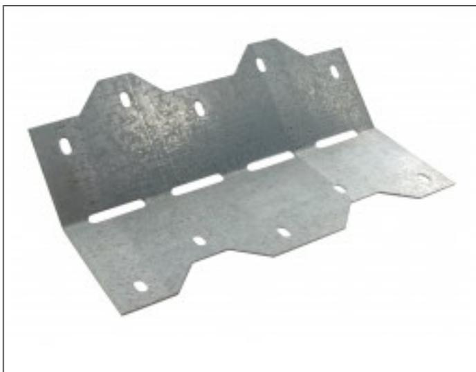
L'équerre à angle ajustable LS est réglable sur chantier de 0 à 135 °. Elle n'est pliable qu'une fois.
