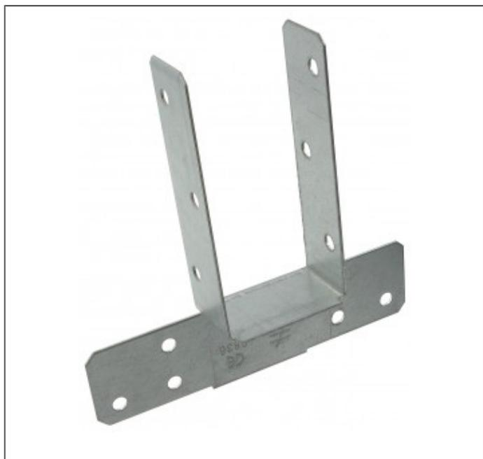
Les pieds de fermettes permettent un ancrage rapide et précis des fermettes, chevrons ou solivettes. Le modèle à plat est utilisé principalement pour reprendre des efforts horizontaux. Le modèle plié est plus adapté aux efforts de soulèvement importants. Le PFP permet de raccorder un chevron avec la sablière ou un poteau. Il assure ainsi la reprise du soulèvement des fermes situées au droit des pignons.
