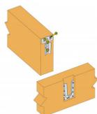
L'étrier à queue d'aronde en acier ETSN est un connecteur innovant et très discret. Il permet de reproduire l'esthétique d'un assemblage traditionnel à queue d'aronde. La partie femelle est placée sur la poutre porteuse avec des vis CSA ou des pointes CNA, tandis que la partie mâle est fixée à l'extrémité de la poutre portée avec les vis à tête plate.
