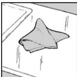
2. Humidifier la surface dans les sens des fibres de bois à l'aide d'un chiffon non peluchant.
