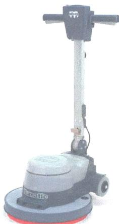
Nous préférons toujours donner l'avantage au disque abrasif qu'au papier de verre. Utilisez un disque abrasif avec grain 60, 80 ou 100'.
